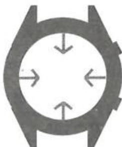
**Boutons :** Appuyer longuement pendant 3 secondes pour allumer/éteindre. Une pression courte permet de revenir à l'interface principale. L'écran s'assombrit par une pression courte à partir de l'interface du cadran de l'horloge.
